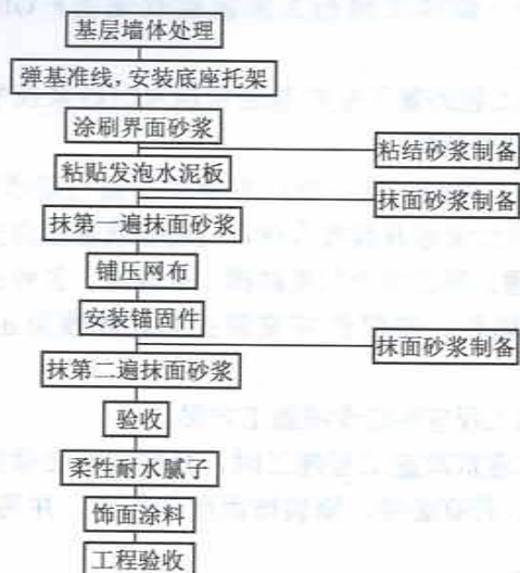
图 6.3.1-1 外墙外保温系统单网施工工艺流程
